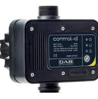
Le CONTROL D est une unité de commande et de protection pour les pompes domestiques sans réservoir à membrane. Grâce à la mesure de débit et de pression intégrée, le CONTROL D peut commander le démarrage et l'arrêt de la pompe ainsi que sa mise en sécurité lors de manque d'eau. L'installation sur la pompe est très aisée.
