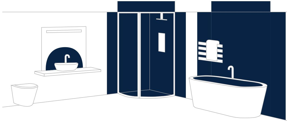
Lorsque vous installez Waves dans une salle de bains, vous devez tenir compte du fait que celle-ci est divisée en 4 zones (de 0 à 3). Selon la classe IP, l'appareil peut être installé dans la zone 2 ou 3.
