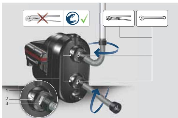
Fig. 3 Montage des raccords
